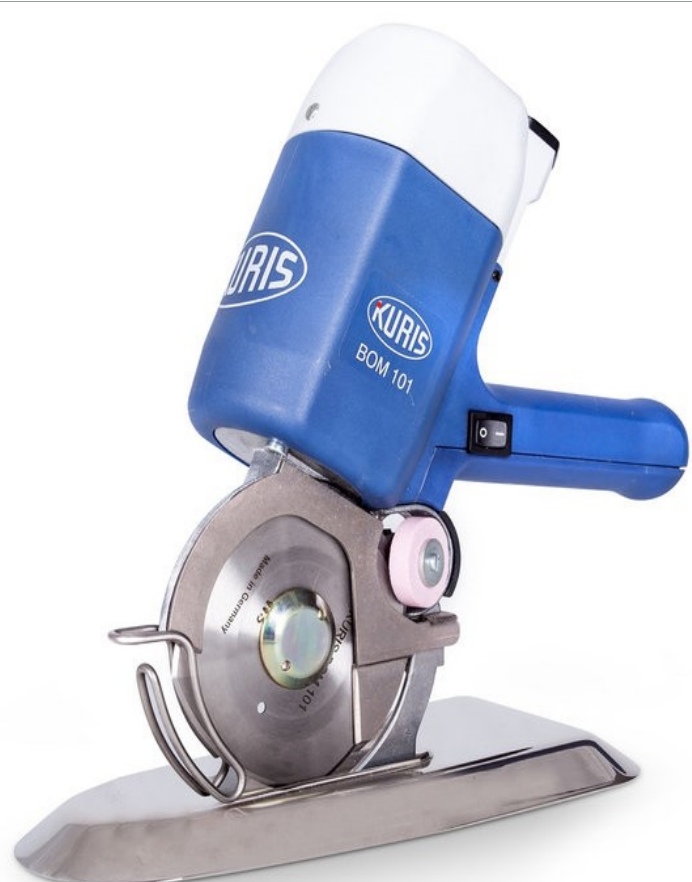
Abb. 3: Rundmessermaschine zur Trennung des FAUSST-Gewirks
