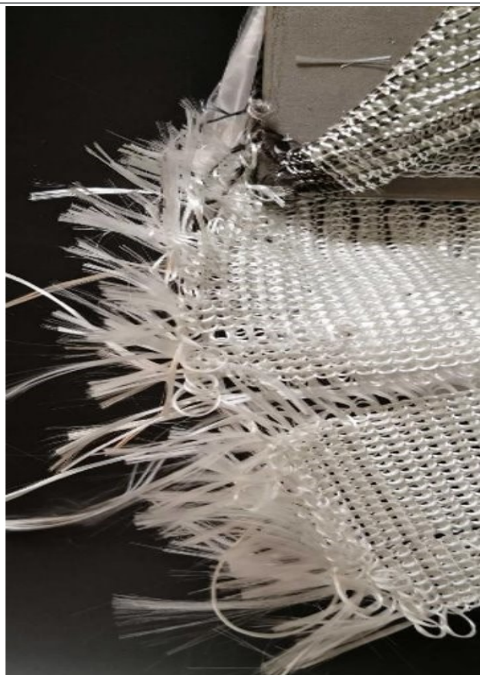
Abb. 2: Aufrüppelung des Gewirks ohne Versiegelung
