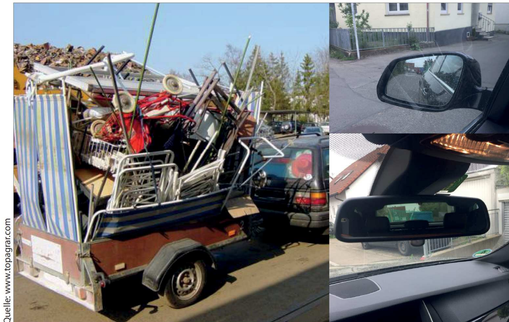
Abb. 1: Unzureichende Ladungssicherung und Ladungskontrolle
