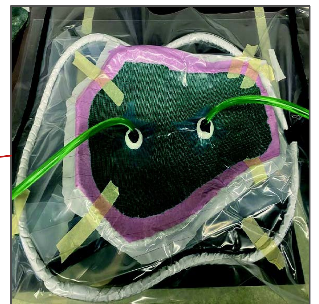
Abb. 4: Vakuumprozess zur Herstellung des Funktionsmuster
