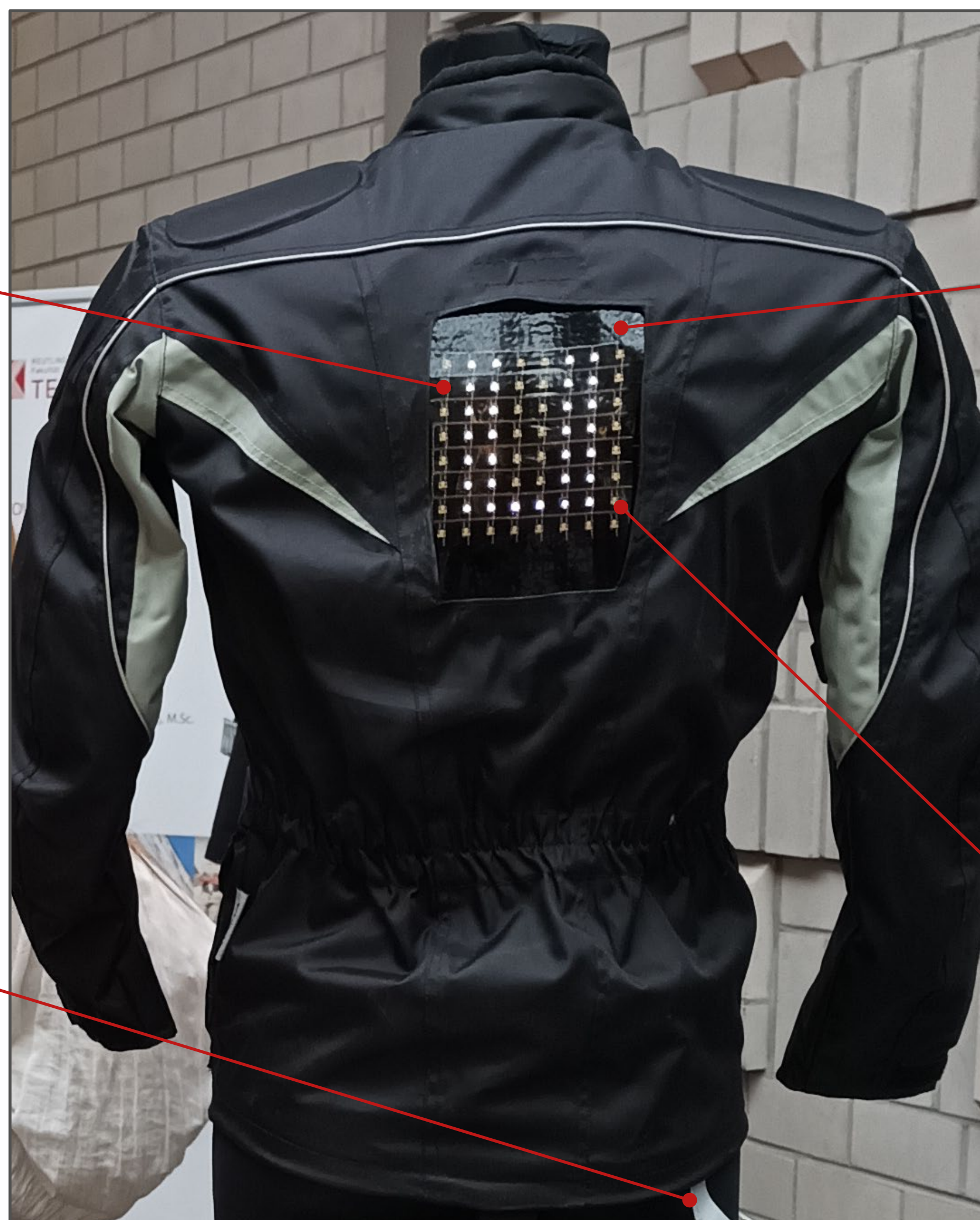
Abb. 6: Funktionsmuster Rückenprotektor für Motorradfahrer mit integrierten LEDs zur Darstellung von Zeichen, Buchstaben, Symbolen und Laufschrift
