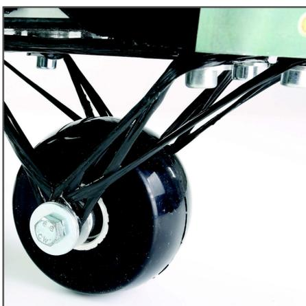
Abb. 4: Leichtbau Hinterachse / Bionic
