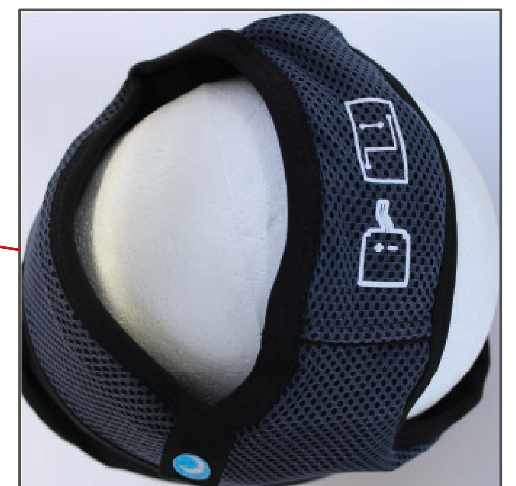
Abb. 4: Maske von oben mit einlegbaren Bauteilen durch Ikonen gekennzeichnet
