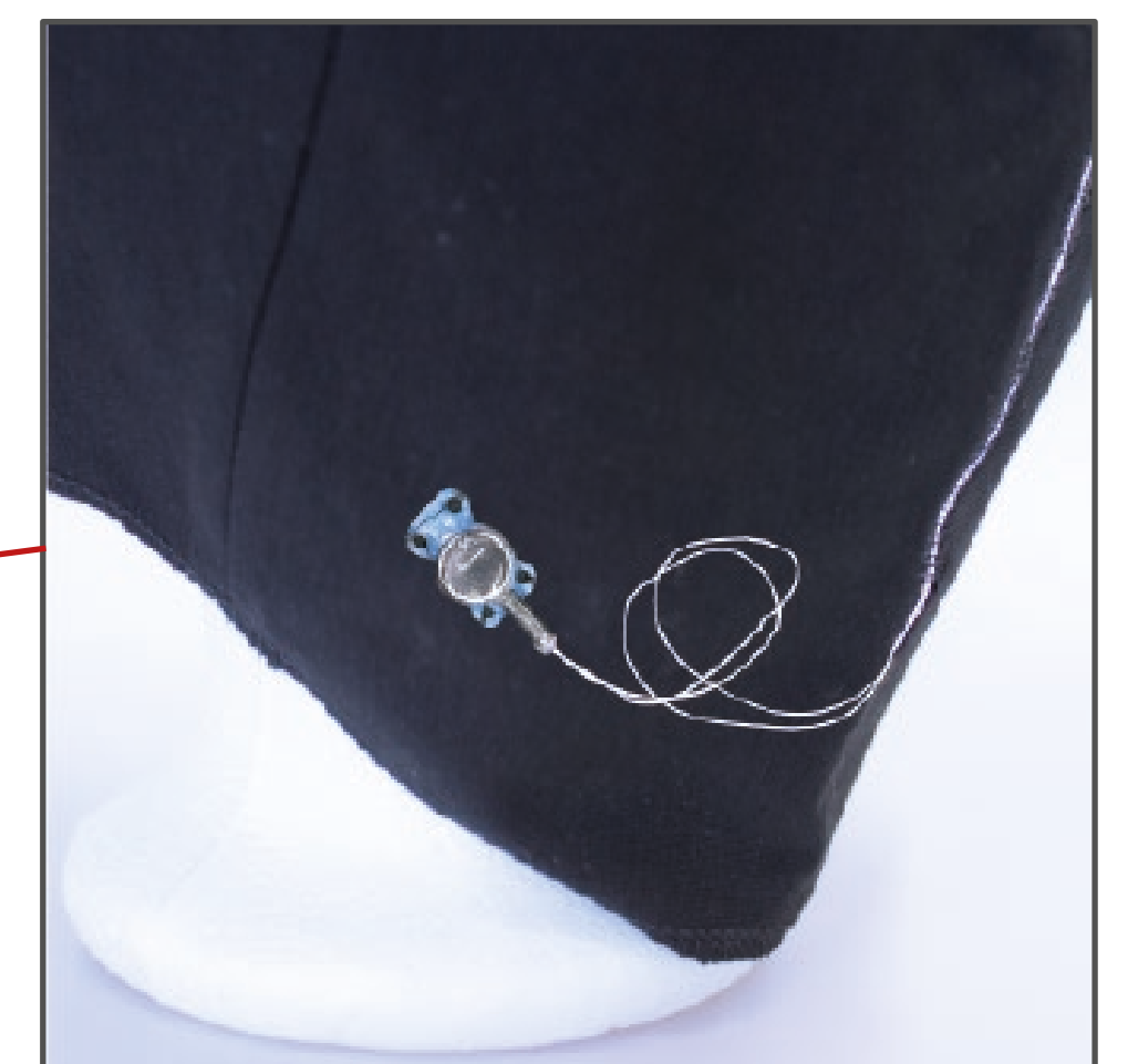
Abb. 5: Eingenähte verkapselte Vibrationsmotoren des Massagesystems
