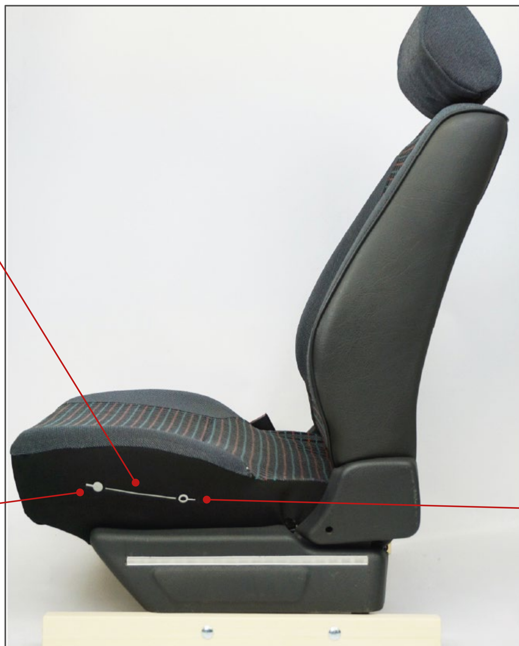
Abb. 6: Smart Seat mit textilem Schalter, Seitenansicht
