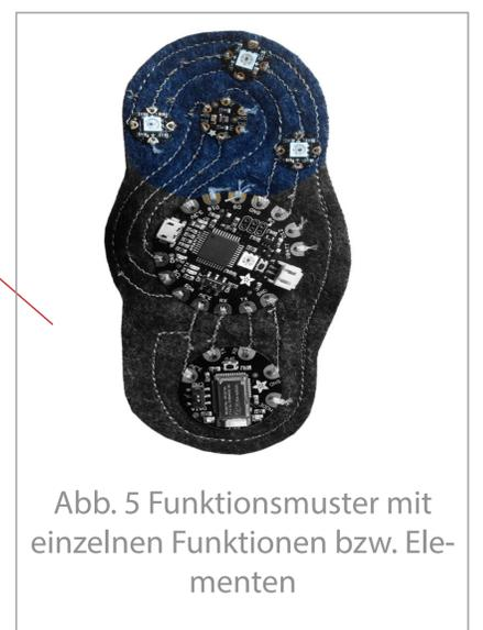
Abb. 5 Funktionsmuster mit einzelnen Funktionen bzw. Elementen
