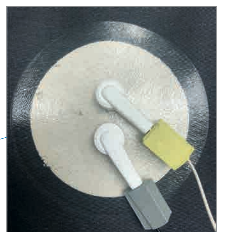
Abb. 9: Gedruckter kapazitiver Sensor zur Bedienung des Lichts
