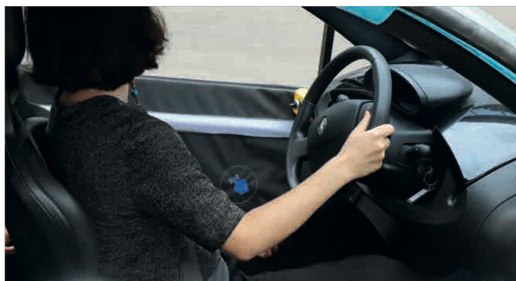
Abb. 6: Eingebaute textile Fahrzeugtüre bei einem Fahrtstest zum Testen der Funktionen
