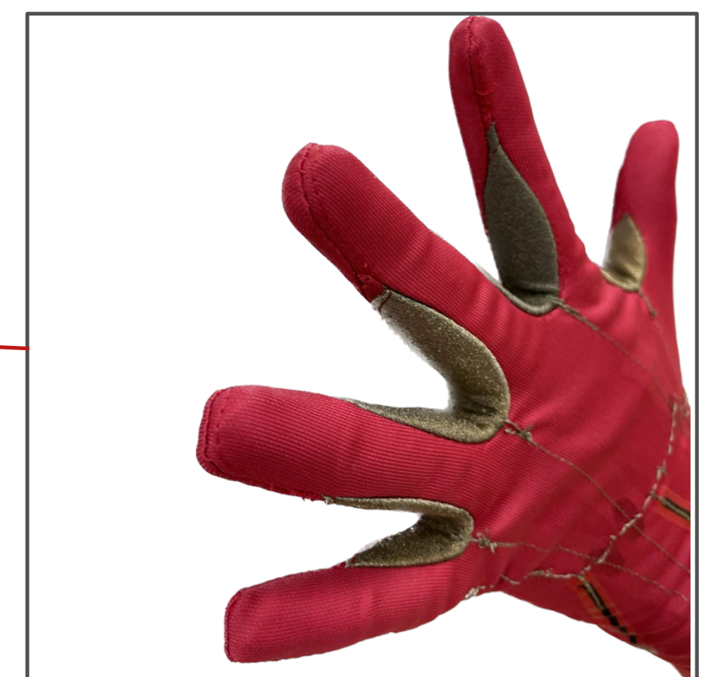
Abb. 4: Realisierung der kapazitiven Sensoren durch ein mit Silber metallisiertes Gewirk
