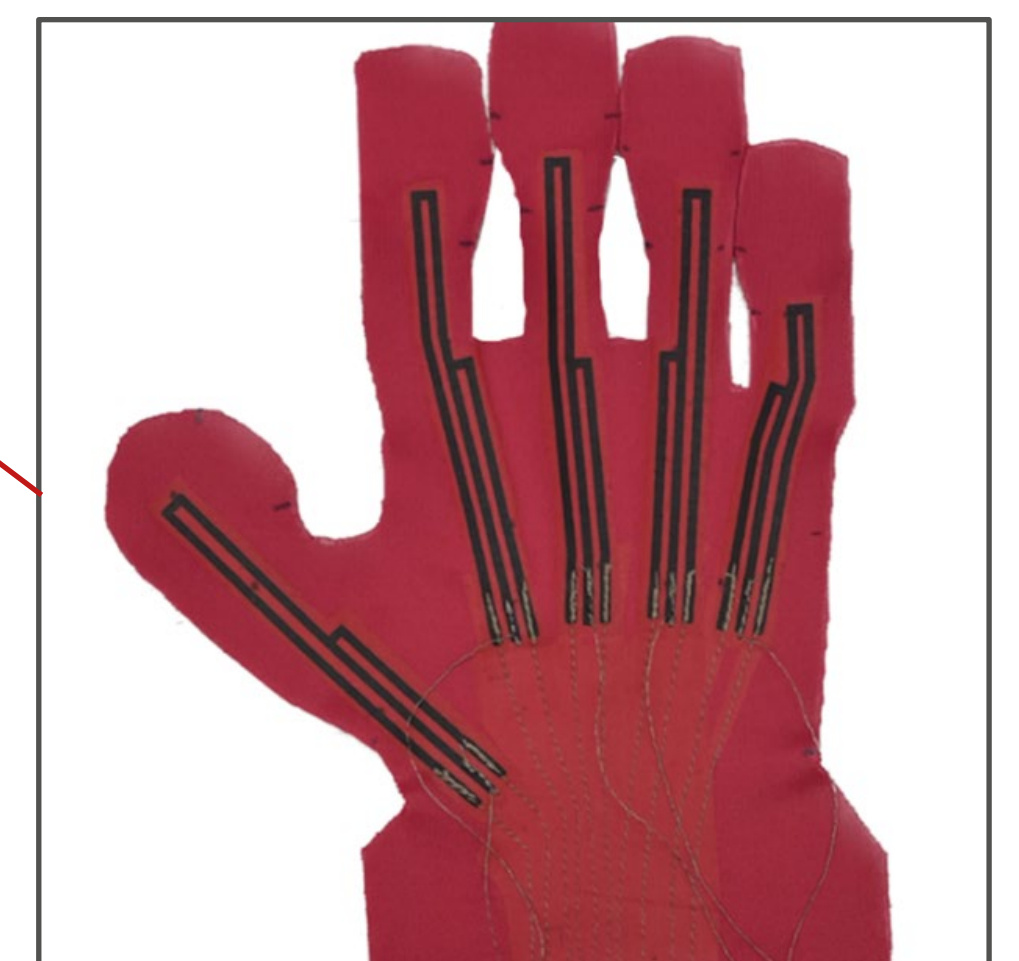
Abb. 5: Realisierung der resistiven Sensoren durch siebgedruckte Carbon-Sensoren
